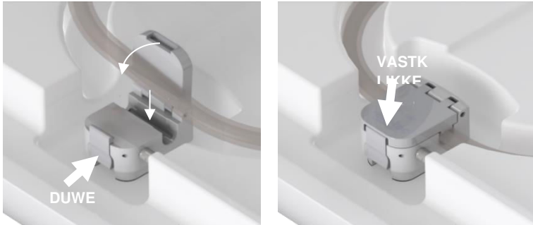
Afbeelding 13: Aansluiting van de stromingssensor
