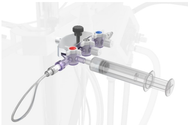
Afbeelding 20 Ontlucht de monsterleiding door lucht op te zuigen met een spuit. Zorg ervoor dat het rode ventiel in de getoonde stand staat.
