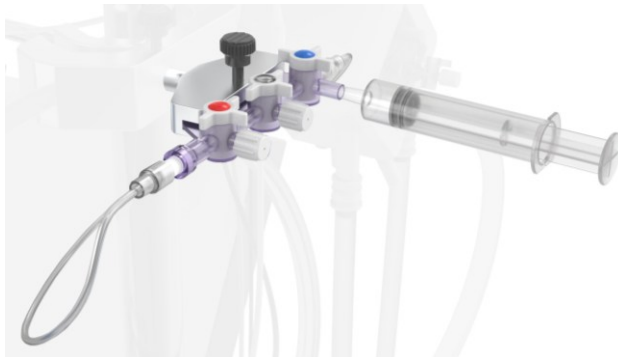
Abbildung 20 Entlüften des Oxygenators über die Probenleitung durch Aspiration mit einer Spritze. Das blaue Ventil muss sich in der angezeigten Ausrichtung befinden.
