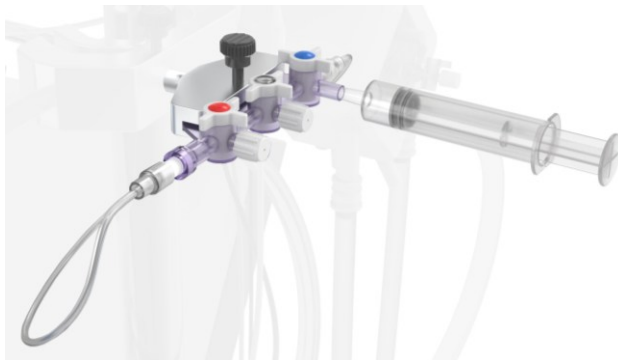
Figura 20 Desairear el oxigenador a través de la línea de muestras aspirando con una jeringa. Asegúrese de que la válvula azul está en la orientación indicada.
