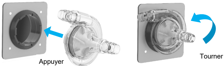
Figure 11 Raccordement de la tête de pompe
