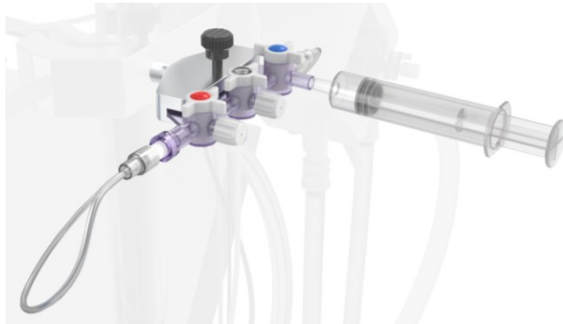
Figura 20 Deaerazione dell'ossigenatore attraverso la linea di campionamento aspirando con una siringa. Assicurarsi che la valvola blu sia orientata come indicato.
