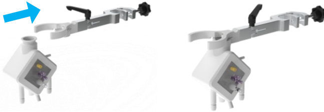
Afbeelding 10 Bevestiging van de oxygenator in de houder
