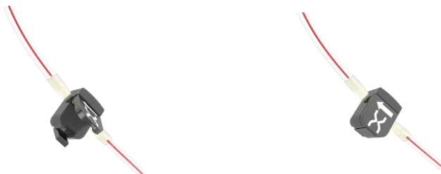
Afbeelding 16 Aansluiting van de stromingssensor op de perfusieset
