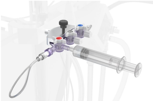
Afbeelding 21 Ontlucht de oxygenator via de monsterleiding door lucht op te zuigen met een spuit. Zorg ervoor dat het rode ventiel in de getoonde stand staat.
