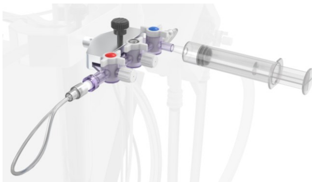
Obrázek 21 Odvzdušnění oxygenátoru přes vzorkovací vedení pomocí injekční stříkačky. Ujistěte se, že modrý ventil je v uvedené poloze.
