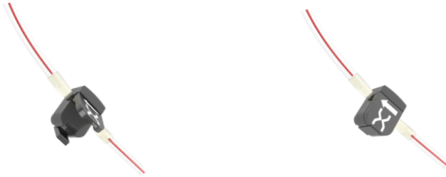
Εικόνα 17 Σύνδεση αισθητήρα ροής στο σετ αιμάτωσης
