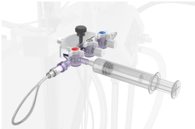
Figura 22 Desairear el oxigenador a través de la línea de muestras aspirando con una jeringa. Asegúrese de que la válvula roja está en la orientación indicada.
