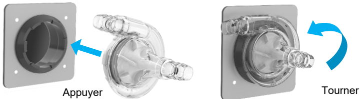
Figure 12 Raccordement de la tête de pompe
