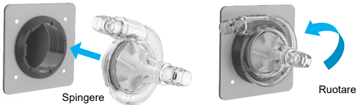
Figura 12 Collegamento della testa della pompa
