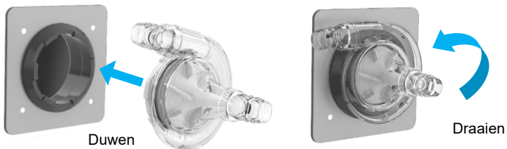
Afbeelding 12 Aansluiting van de pompkop
