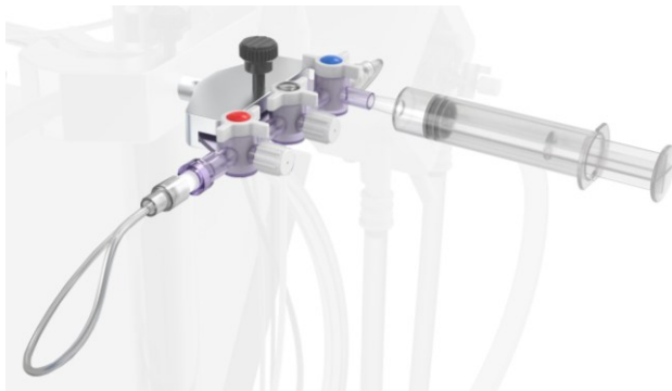
Rysunek 21 Odpowietrzanie oksygenatora przez linię próbkującą poprzez aspirację strzykawką. Sprawdź, czy niebieski zawór znajduje się we wskazanej orientacji.
