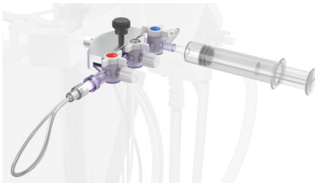
Figura 19 Desairear de la línea de muestra aspirando con una jeringa. Asegúrese de que la válvula azul esté en la orientación indicada.
