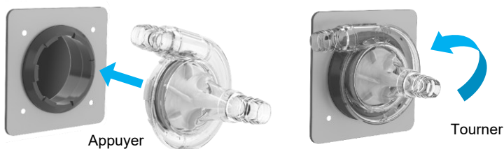
Figure 10 Raccordement de la tête de pompe
