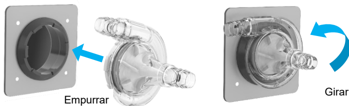
Figura 10 Conexão do cabeçote da bomba
