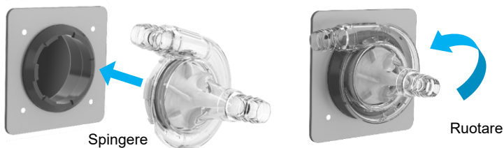
Figura 12 Collegamento della testa della pompa
