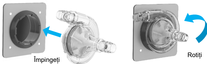
Figura 12 Conectarea capului pompei
